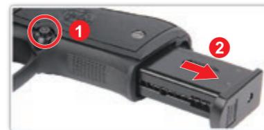
1. Appuyez sur l'arrêtoir de chargeur. 2. Retirez le chargeur.
