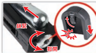
彈匣底座往下敲，彈出彈匣底座工具並使用彈匣底座工具鬆開CO2氣瓶旋蓋，放入CO2氣瓶，再鎖緊旋蓋。
