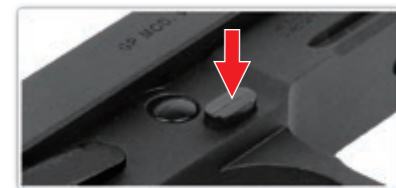
壓下滑套分解桿。
