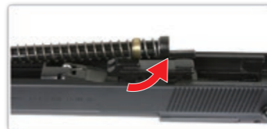
リコイルスプリングを圧縮したまま、ガイドを引き抜きます。
